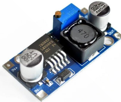
ภาพที่ 3.21 Voltage step down module 3.3VDC, 5VDC
