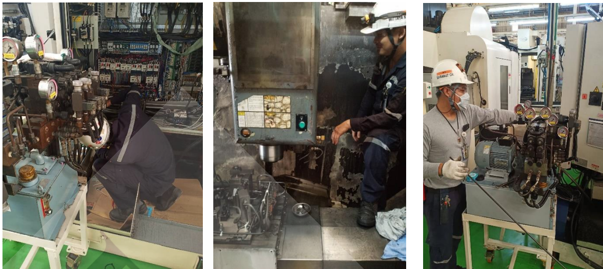
ภาพที่ 3.32 ตัวอย่างการตรวจเช็คประจำเดือนเครื่องจักรซีเอ็นซี
