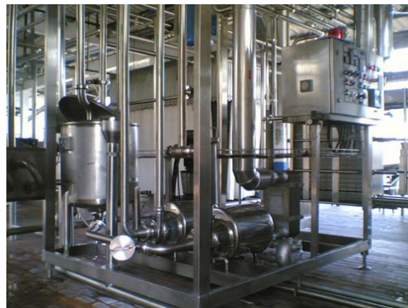
ภาพที่ 2.6 แสดงระบบพาสเจอร์ไรซ์แบบต่อเนื่อง (continuous pasteurization)
