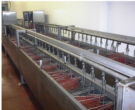
ภาพที่ 2.4 แสดงระบบพาสเจอร์ไรซ์ในภาชนะปิดผนึกสนิท
