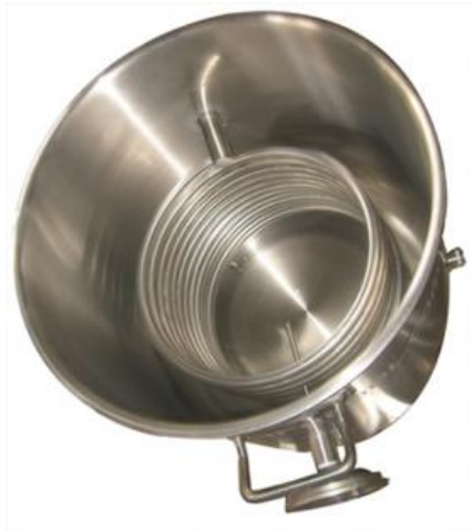
ภาพที่ 4.2 แสดงภายในถังพาสเจอร์ไรซ์ ทำด้วยขดท่อวน สแตนเลสคุณภาพ ใ้กับอาหารได้
