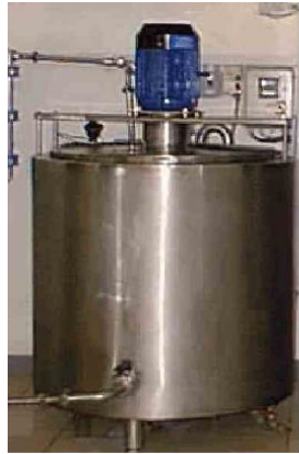
ภาพที่ 2.5 แสดงระบบพาสเจอร์ไรซ์แบบเป็นกะ (batch pasteurization)
