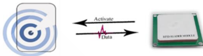
ภาพที่ 3.13 การสื่อสารระหว่างเครื่องอ่านและแท็ก RFID
