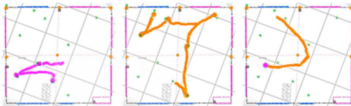
ภาพที่ 4.11 แสดงการติดตามตำแหน่งของรถ ตั้งแต่เส้นทางก่อนถึงจุดเก็บม้วนกระดาษ (ซ้าย) เส้นทางขณะที่รถกำลังเคลื่อนย้ายม้วนกระดาษ (กลาง) และเส้นทางที่ผู้ขับรถวางม้วนกระดาษที่จุดปลายทาง (ขวา)
