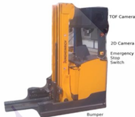
ภาพที่ 2.6 รถยก ETV 216 ที่ถูกพัฒนาขึ้นมาใช้กับวิธีการนำทางด้วยกล้อง TOF แบบ 3 มิติ
