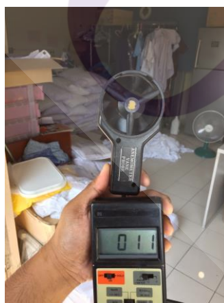
ภาพที่ 4.19 ตรวจสอบวัดแรงลมบริเวณห้องซักรีด
