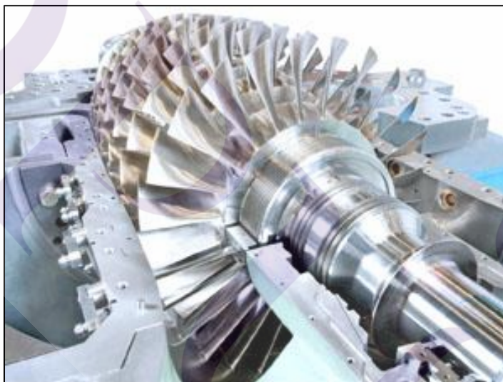
ภาพที่ 2.2 เครื่องอัดและเพิ่มความดันแบบอัดในแนวแกน Axial Compressor
