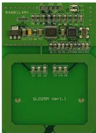
ภาพที่ 2.6 เครื่องอ่านRFID 13.56MHz Read/Write Mifare Module (UART TTL)
