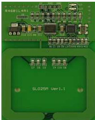
ภาพที่ 3.1 เครื่องอ่าน RFID 13.56MHz Read/Write Mifare Module (UART TTL)
