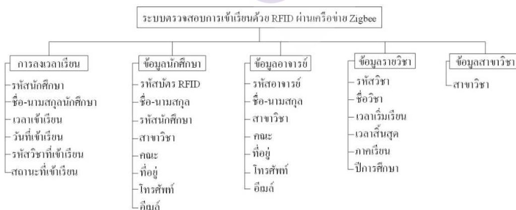
ภาพที่ 3.15 แผนภาพโครงสร้างของระบบตรวจสอบรายชื่อการเข้าเรียนด้วย RFID ผ่านเครือข่าย ZigBee รูป ก
