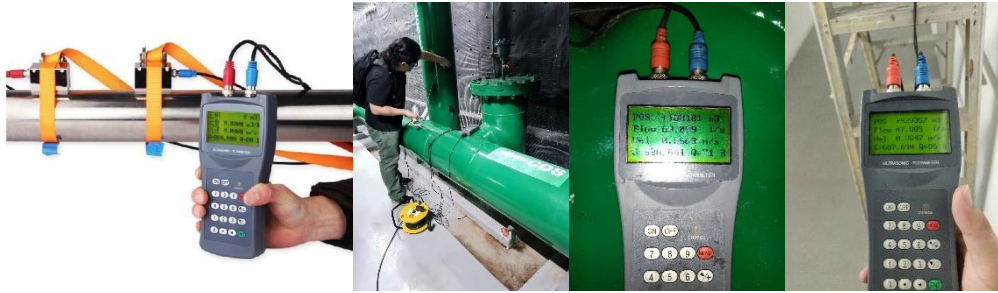
ภาพที่ 3.6 การใช้เครื่องมือวัดอัตราการไหลของน้ำแบบอัลตราโซนิคมีทั้งระบบ Data Logger และ สปอตเช็ค
