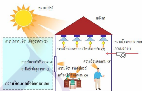
ภาพที่ 2.1 แหล่งความร้อนต่างๆของอาคารปรับอากาศ
