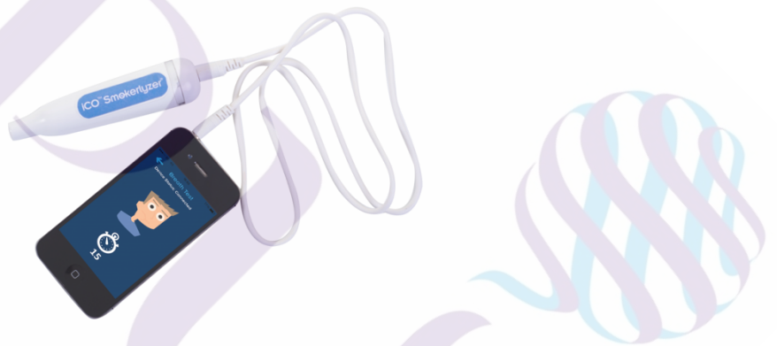
ภาพที่ 3.1 เครื่องวัดปริมาณก๊าซคาร์บอนมอนอกไซด์ลมหายใจออก
