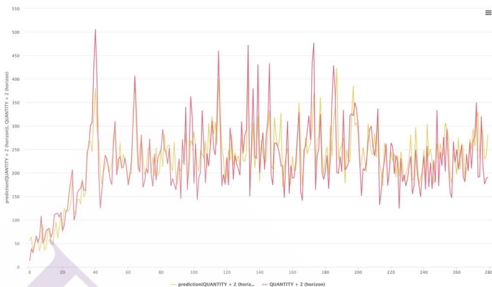
ภาพที่ 4.21 กราฟข้อมูลของปริมาณขายจริง (สีแดง) เทียบกับข้อมูลพยากรณ์ (สีเหลือง) ของชุดข้อมูลสินค้าทั้งหมดหมู่ที่ขายดีที่สุด เมื่อทำการเพิ่มตัวแปรภายนอก (เช่น วันของสัปดาห์ วันทำการและวันหยุดของสัปดาห์ และสัปดาห์ของเดือน) ด้วยเทคนิค Gradient Boosted Trees สำหรับการพยากรณ์ในอีก 2 วันถัดไป เมื่อพิจารณาจากข้อมูลย้อนหลัง 7 วัน
