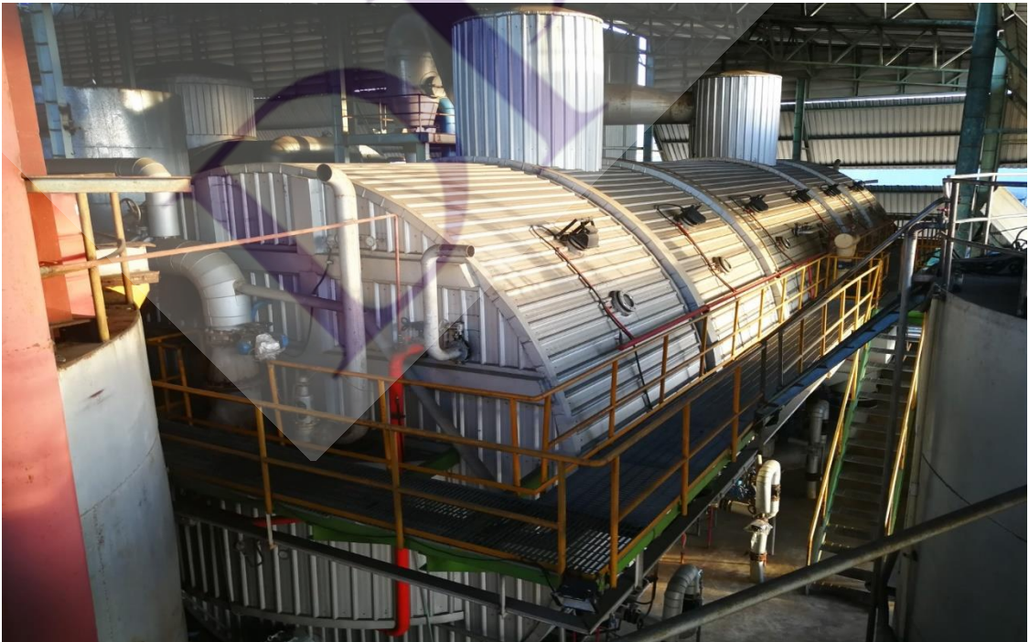
ภาพที่ 2 หม้อเคียวชนิดนอน ใช้เพื่อเคียวน้ำเชื่อมดิบให้เกิดผลึกน้ำตาล
