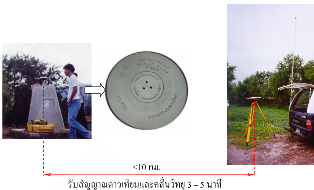
ภาพที่ 4.5 การถ่ายโอนค่า GPS Control โดยวิธีแบบจลน์ในทันที (RTK) สร้างหมุดหลักฐานแผนที่เพื่อความสะดวกรวดเร็วในการทำงาน
