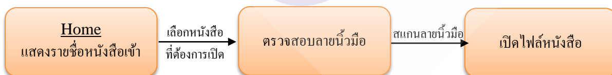
ภาพที่ 3.25 ออกแบบหน้าต่างเว็บไซต์สำหรับตรวจสอบลายนิ้วมือ
