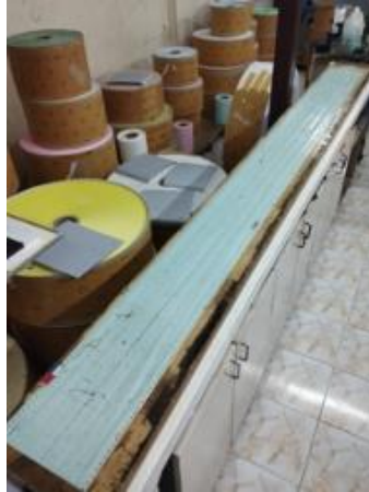
ภาพที่ 4.6 ภาพแสดงแท่นตรวจวัดโดยนำกระดาษมาวางทาบบนแท่นและใช้สายตาวัดพนักงานตรวจสอบ
