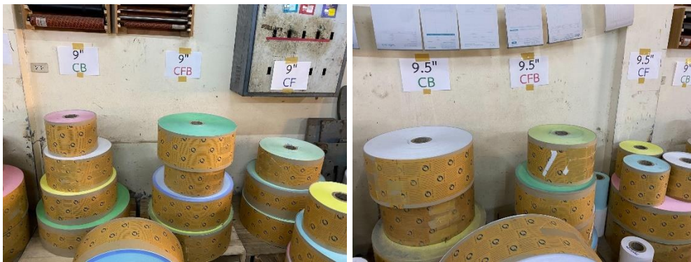
ภาพที่ 4.5 ป้ายบ่งบอกชนิดของกระดาษป้องกันการหยิบกระดาษผิดพลาด
