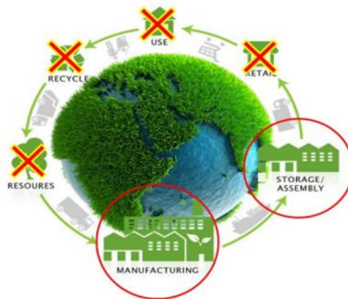
ภาพที่ 2.8 แสดงวัฏจักรของการวิเคราะห์ Life Cycle แบบ Gate to Gate
