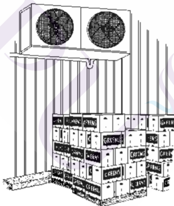
ภาพที่ 2.11 การลดอุณหภูมิแบบ Room Cooling
