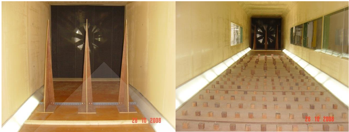
ภาพที่ 3.2 การติดตั้ง Spires และ Roughness Element ภายในอุโมงค์ลม
