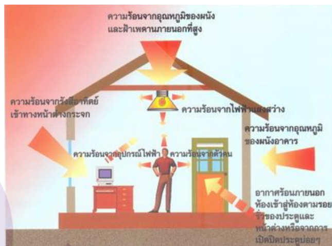
ภาพที่ 2.2 แหล่งความร้อนต่างๆ ของการปรับอากาศ
