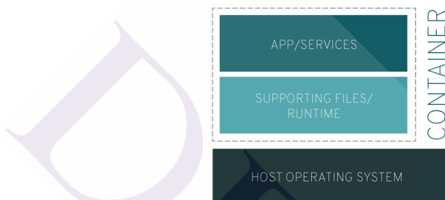
ภาพที่ 2.3 แนวคิดของเทคโนโลยี Software Container 4
