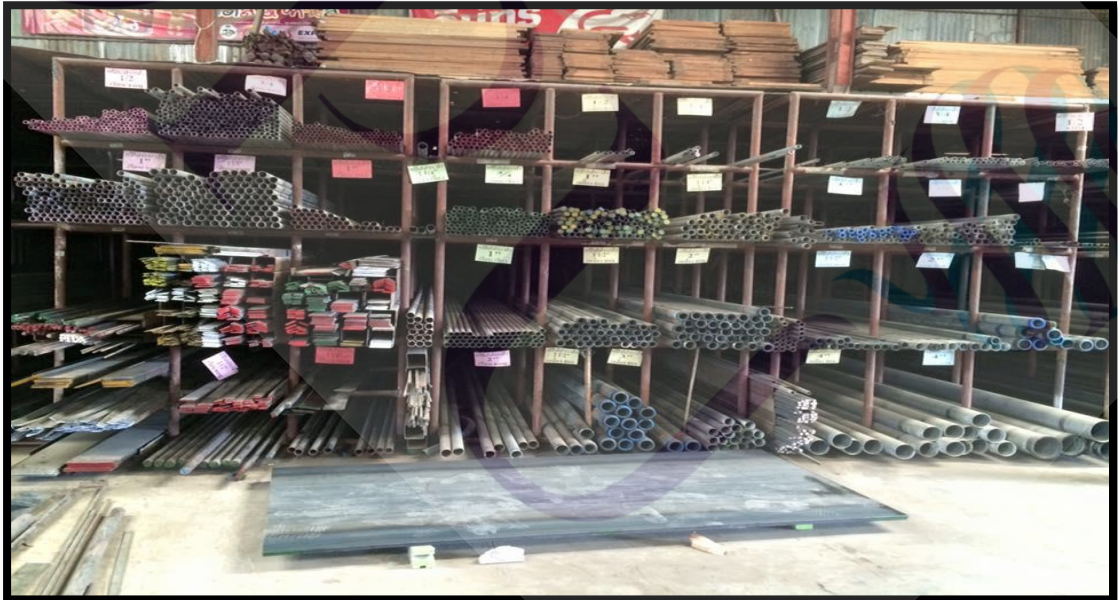
ภาพที่ 4.9 มีการนำแผ่นเหล็กวางบริเวณการหยิบสินค้า มีการวางพื้นเหล็กขวางทางเดิน พนักงานนำพื้นเหล็กมาใช้สำหรับ แล้วไม่นำไปเก็บทำให้ ขวางทางเดิน
