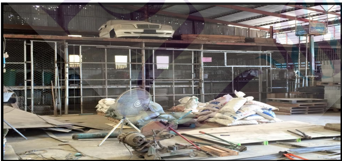
ภาพที่ 4.7 มีการวางสินค้าและอุปกรณ์บริเวณทางเดิน
