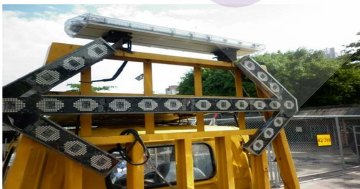
ภาพที่ 4.13 ไฟฉุกเฉินบนรถยนต์กู้มครอง ของ บริษัททางด่วนกรุงเทพ จำกัด (มหาชน)
