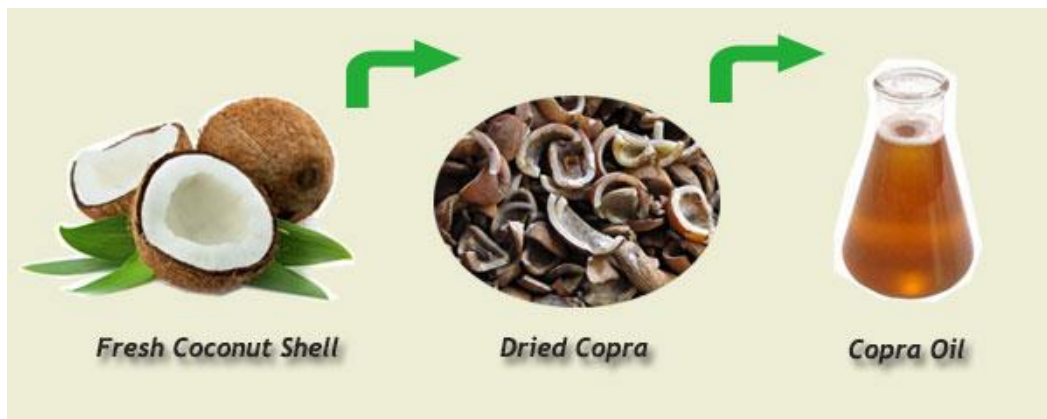
ภาพที่ 2.2 การผลิตน้ำมันมะพร้าว จากมะพร้าวแห้ง 7
