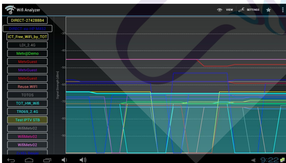
ภาพที่ 4.6 แสดงพื้นที่ที่มีสัญญาณ WiFi หนาแน่น โดยแสดงค่า RSSI ของ SSID “Test IPTV STB”
