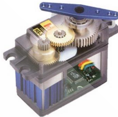
ภาพที่ 2.14 ลักษณะโดยทั่วไปของเซอร์โวมอเตอร์
