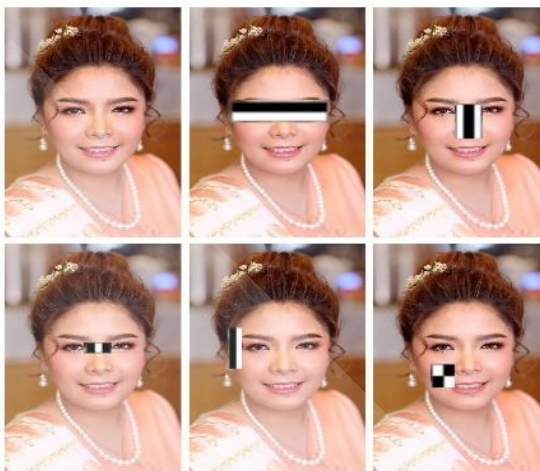
ภาพที่ 2.6 แสดงตัวอย่างของตัวจำแนกแบบแข็งแกร่งที่ได้จากระบวนการเรียนรู้ด้วย Adaboost
