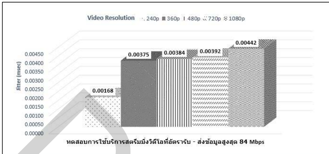
ภาพที่ 4.3 เปรียบเทียบค่าความแปรปรวนของความล่าช้าทางเวลา (Jitter) ของบริการสตรีมมิ่งวิดีโอ บนโครงข่าย LTE แบบเดิมและโครงข่าย LTE ที่นำเสนอ โดยใช้อัตราการรับ – ส่ง ข้อมูลสูงสุด 84Mbps และใช้ Video Resolution ที่ต่างกัน 5 ประเภทคือ 1080P, 720P, 480P, 360P และ 240P
