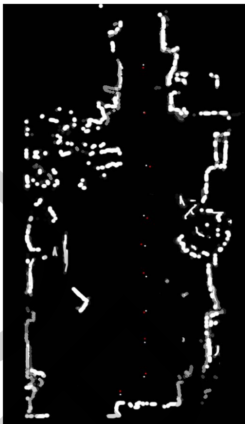
ภาพที่ 4.10 ภาพแสดงตำแหน่งของหุ่นยนต์จากโปรแกรมระบุตำแหน่งกับตำแหน่งจริง
