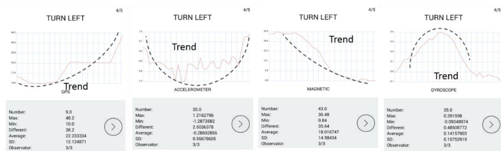
ภาพที่ 3.23 ความสัมพันธ์ของเซ็นเซอร์กับการเลี้ยวซ้าย
