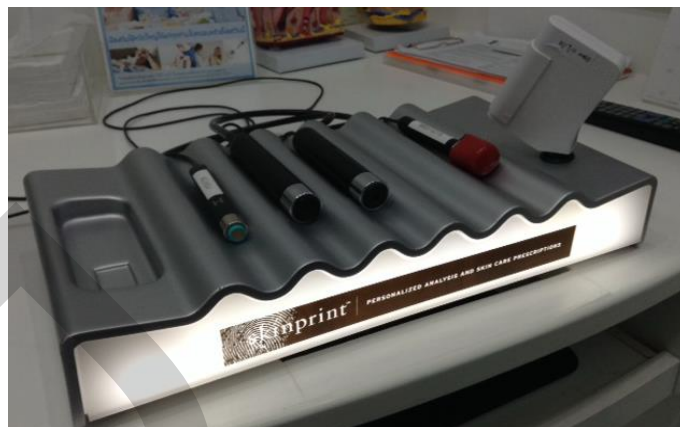
ภาพที่ 2.6 เครื่องมือ Skinprint ที่มีหัวตรวจสอบสภาพผิวต่างๆ เช่น ความชุ่มชื้น ความยืดหยุ่น เป็นต้น
