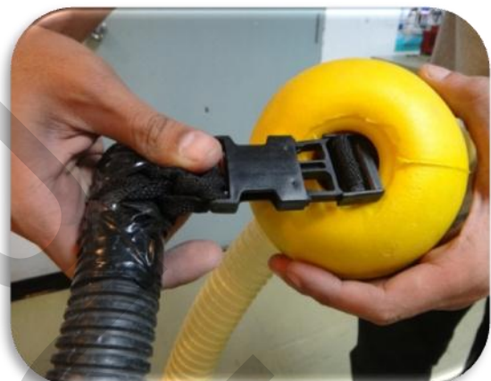
2. นำสายทุ่นลอยน้ำอีกด้านหนึ่งเชื่อมต่อกับสายสัญญาณควบคุมทุ่นขนัต
