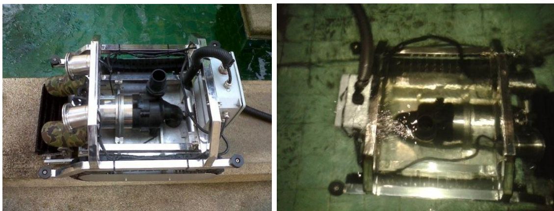
ภาพที่ 4.4 การทดสอบประสิทธิภาพหุ่นยนต์ในการเคลื่อนที่ที่มีสภาพพื้นผิวมันและหยาบ
