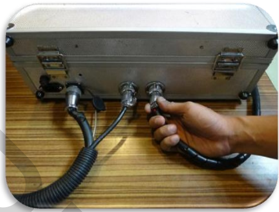
นำสายไฟ (6 pin) ของชุดรอกไฟฟ้ามาเชื่อมต่อบริเวณด้านหลังของกล่องควบคุมหุ่นยนต์
