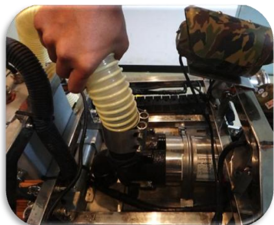
4. นำปลายสายของท่อคูดตะกอนมาเชื่อมต่อกับปั้มน้ำบริเวณด้านบนของทุ่นขนัตคูดตะกอน
