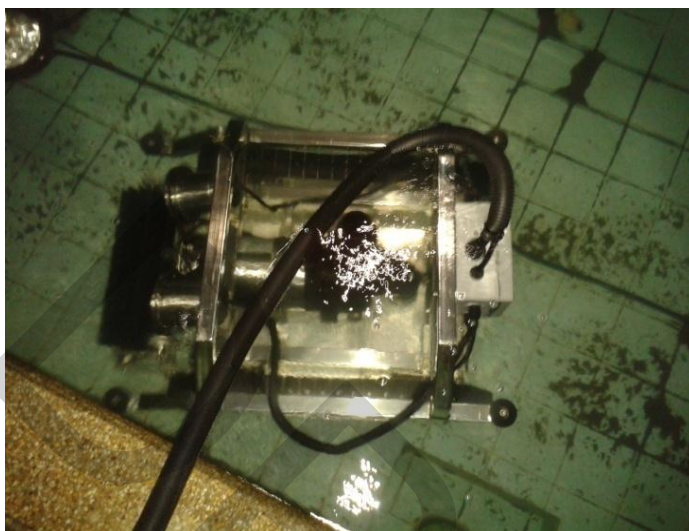
ภาพที่ 4.3 การทดสอบประสิทธิภาพหุ่นยนต์ดูตะกอนใต้น้ำที่มีความลึก 0.8 เมตร
