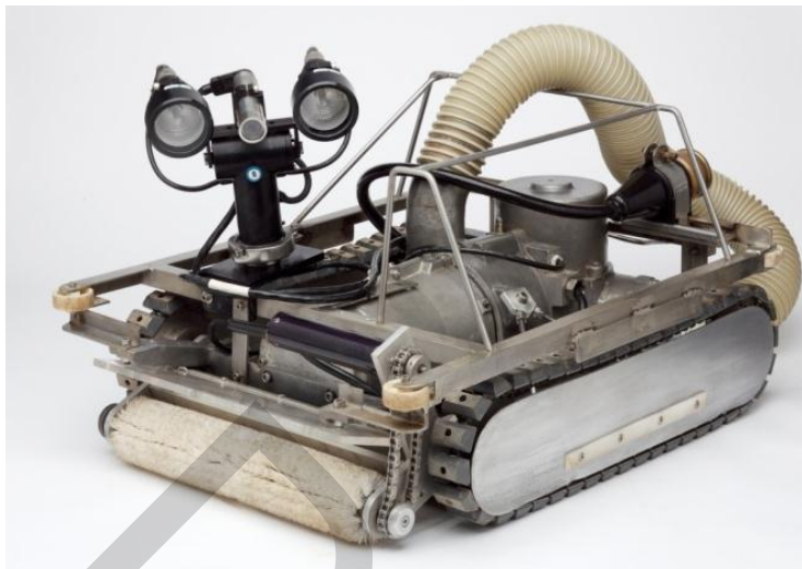
ภาพที่ 2.8 หุ่นยนต์ทำความสะอาดถังเก็บน้ำใต้ดิน VR – 600
