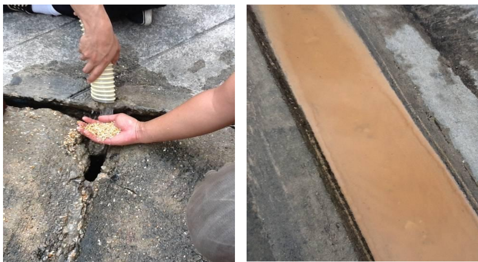
ภาพที่ 4.19 ตะกอนที่ออกท่อน้ำทิ้งจากการทำความสะอาดถังพักน้ำของหุ่นยนต์ดูดตะกอน
