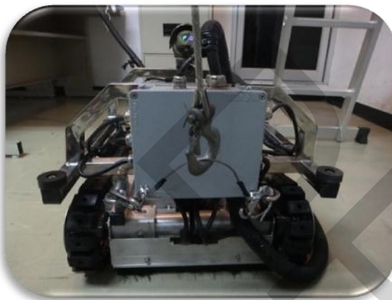
นำตะขอก๊วยที่ติดอยู่กับรอกไฟฟ้ามาเกี่ยวกับสลิงทางด้านหลังของหุ่นยนต์
