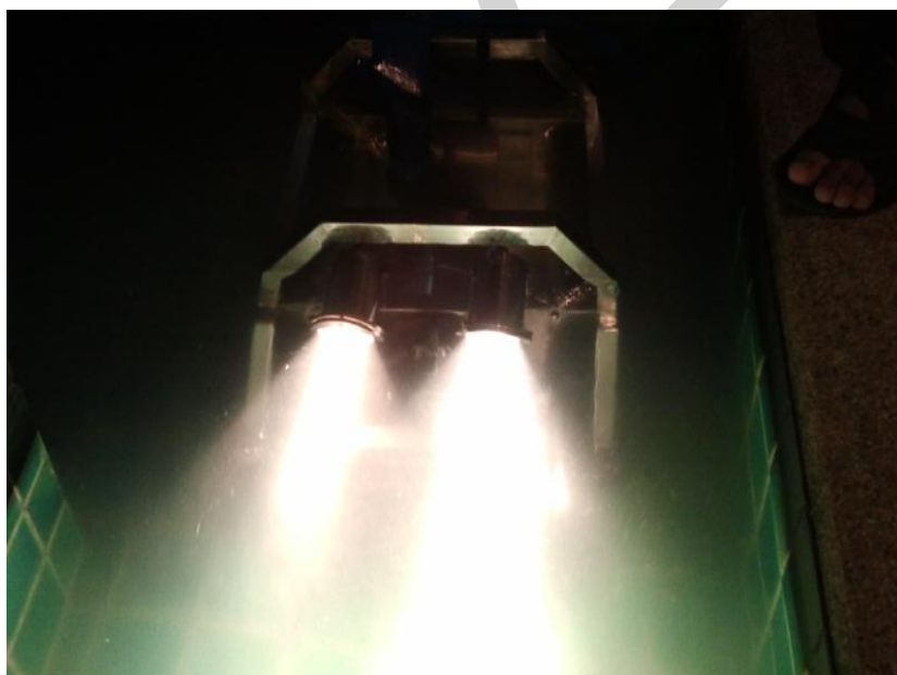
ภาพที่ 4.6 การทดสอบประสิทธิภาพไฟส่องสว่างของตัวผู้ขนยนต์ดูแลก่อนใต้น้ำ
