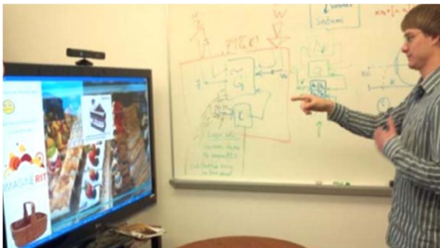
ภาพที่ 2.18 ระบบแสดงผลที่ควบคุมโดยการแสดงท่าทางและการแสดงออกทางหน้าตาของผู้ใช้ ที่มา: ( http://www.deepdyve.com/lp/institute-of-electrical-and-electronics-engineers/interactive-display-using-depth-and-rgb-sensors-for-face-and-gesture-7fV0UGTQ37 )
