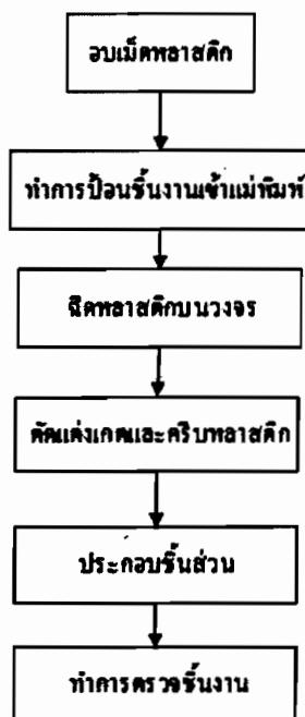
ภาพที่ 3.3 แสดงขั้นตอนกระบวนการนี้ดูคลาสติกบนวงจรอิเล็กทรอนิกส์
