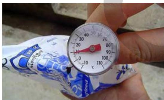
รูปที่ 2.5 ใช้เทอร์โมมิเตอร์แบบก้านเหล็กตรวจสอบอุณหภูมินมพาสเจอร์ไรส์ ณ หน้าโรงจานโดยใช้เทอร์โมมิเตอร์
