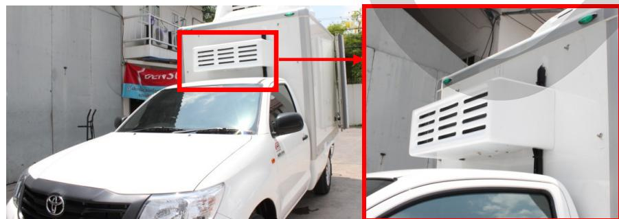
รูปที่ 4.10 ตำแหน่งการติดตั้งคอนเดนเซอร์และรีซีฟเวอร์ของเครื่องทำความเย็นสำหรับรถบรรทุกขนาด 1 ตัน เพื่อขนส่งนม โกร์เรียน
