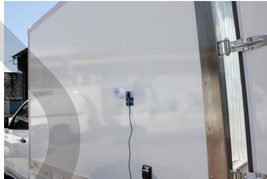
รูปที่ 4.26 สายเซนเซอร์วัดอุณหภูมิกายในตู้ห้องเย็น (Ambient)
