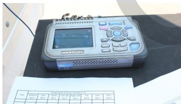
รูปที่ 4.28 เครื่องตรวจวัดอุณหภูมิ Midi Logger GL200ทดสอบการลดอุณหภูมิ (Cool Down Test) ทั้งหมด 8 ตำแหน่ง
