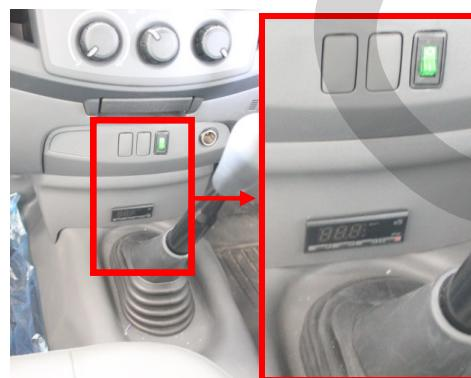
รูปที่ 4.12 ตำแหน่งการติดตั้งเครื่องควบคุมอุณหภูมิของเครื่องทำความเย็นสำหรับรถบรรทุกขนาด 1 ตัน เพื่อขนส่งนมโรงเรียน
