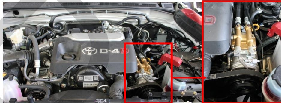
รูปที่ 4.9 ตำแหน่งการติดตั้งคอมเพรสเซอร์ของเครื่องทำความเย็นสำหรับรถบรรทุกขนาด 1 ตัน เพื่อขนส่งนม โกร์เรียน
