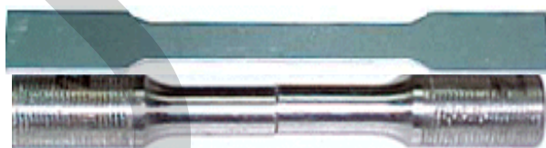
ภาพที่ 2.7 แสดงชิ้นทดสอบแรงดึงแบบแผ่นและแบบแท่ง
