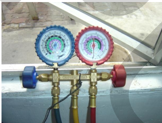
รูปที่ 3.14 เกจวัดความดันของน้ำยาเครื่องปรับอากาศ
