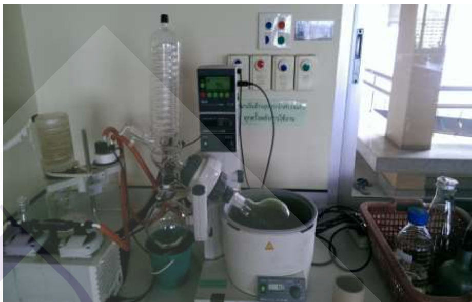
ภาพที่ จ-3 Rotary evaporator (R-205, Buchi, England)
