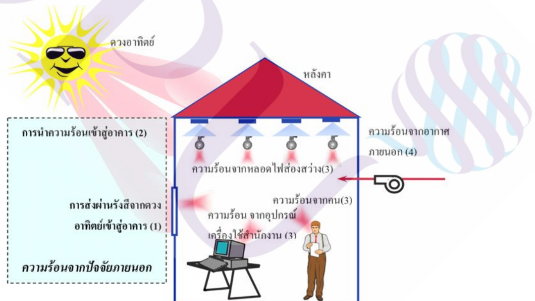
ภาพที่ 2.4 แหล่งความร้อนต่างๆ ของอาคารปรับอากาศ
