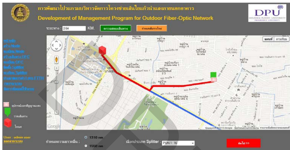
รูปที่ 4.14 แสดงการกำหนดเส้นทาง ความยาวคลื่น และประเภทของอุปกรณ์แยกสัญญาณแสง
