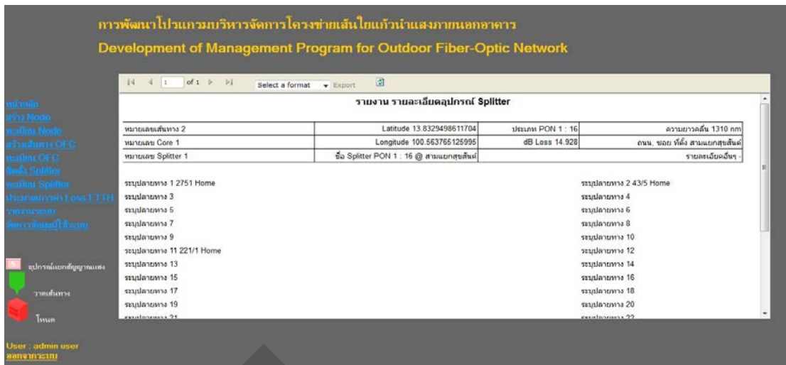
รูปที่ 4.31 แสดงการพิมพ์รายงานข้อมูลการใช้งานของอุปกรณ์แยกสัญญาณแสง
