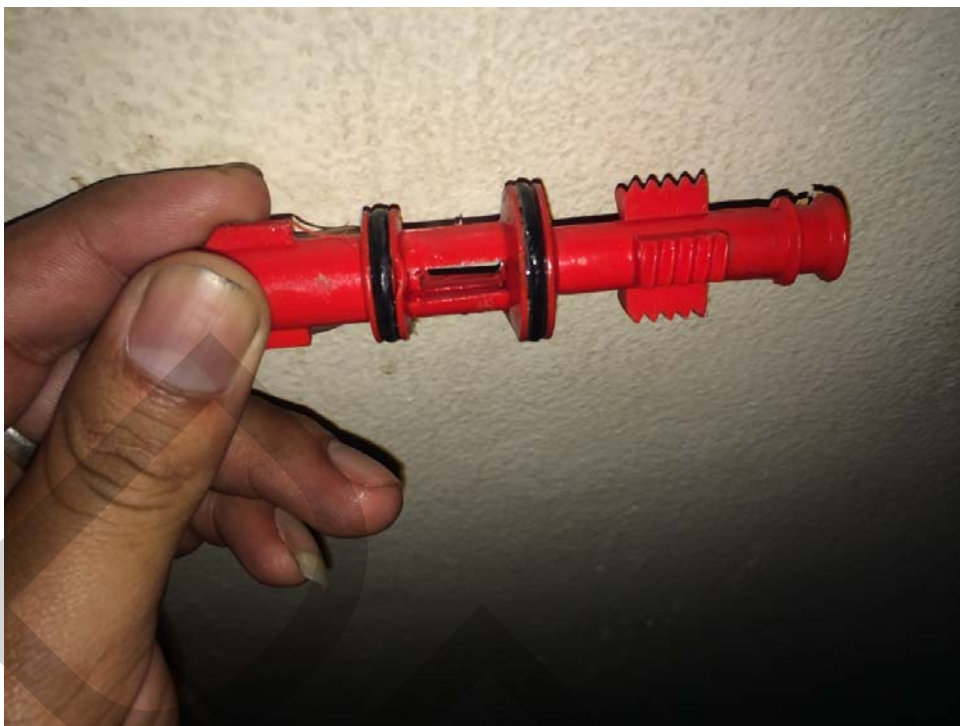
ภาพที่ 7 ปัญหาแกนควบคุมการปรับน้ำหัวฉีดขนาด 1 นิ้ว ที่ชำรุด
