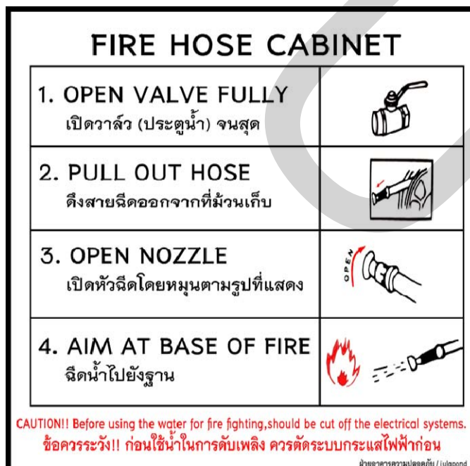
ภาพที่ 5.2 ป้ายคำแนะนำขั้นตอนการใช้งานที่มีสัญลักษณ์ให้สอดคล้องกับอุปกรณ์ภายในตู้สายฉีดดับเพลิง
