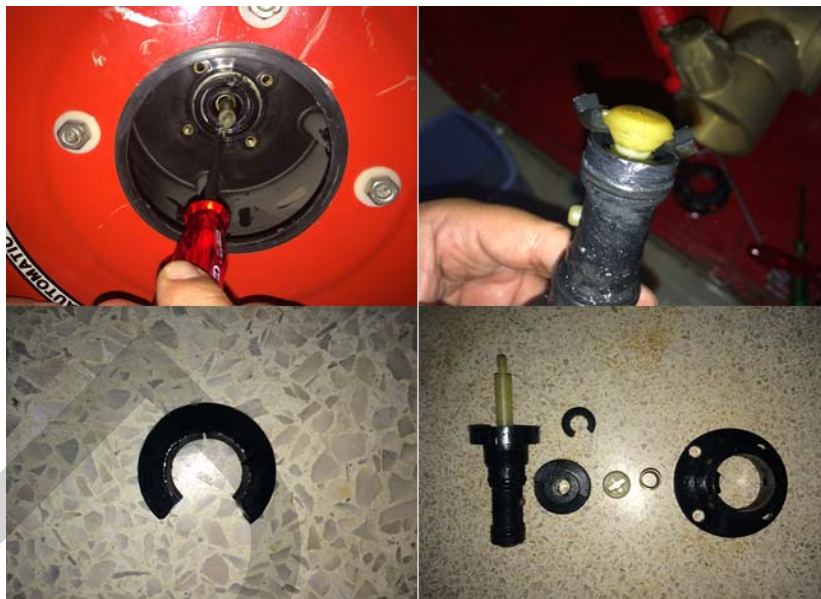
ภาพที่ 1 วาล์ววงล้ออัตโนมัติที่ซีลยางชำรุด
