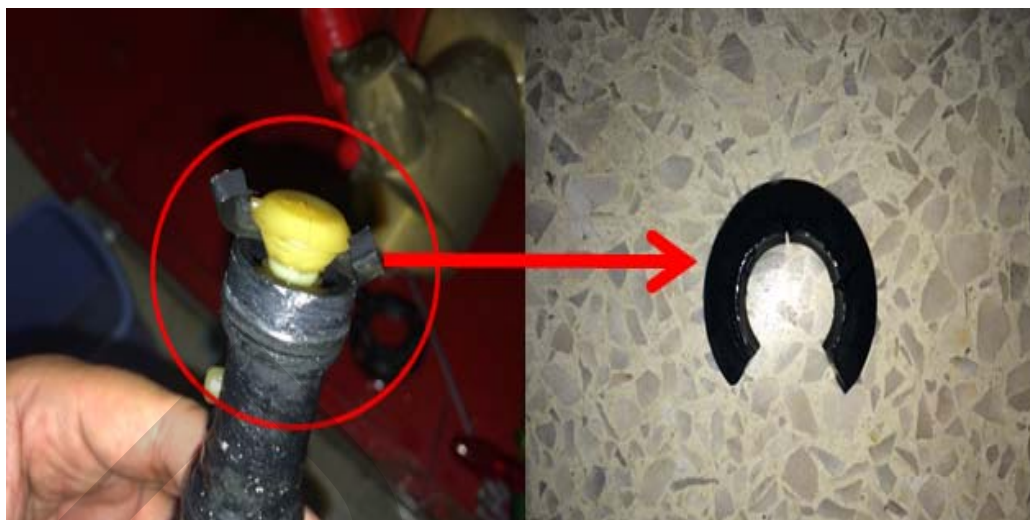
ภาพที่ 4.10 ซีลยางวาล์วน้ำอัตโนมัติภายในงอที่ชำรุด
