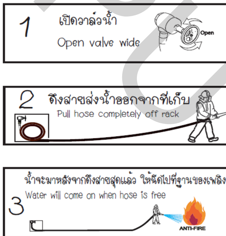
ภาพที่ 3.3 ป้ายแสดงวิธีการใช้งานตู้สายฉีดน้ำดับเพลิงแบบสายยางขนาด 1 นิ้ว
