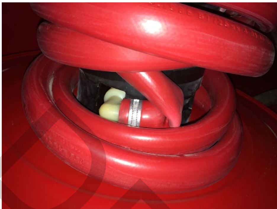
ภาพที่ 3 ตรวจสอบเช็กลวดขนาด 1 นิ้วที่มีรอยพับหักภายในกองลื้อ
