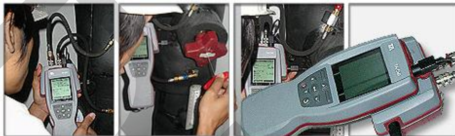
ภาพที่ 0.7 การวัดปริมาณน้ำและการปรับปริมาณน้ำ (Test Flow Rate)
