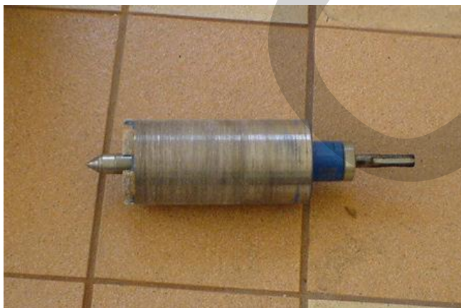
ภาพที่ 0.4 ดอกเจาะโฮลซอว์ (Hole Saw) ขนาด 2.5 นิ้ว สำหรับเจาะกำแพง
