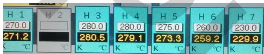
ภาพที่ 4.2 อุณหภูมิ Barrel ที่ไม่คงที่
