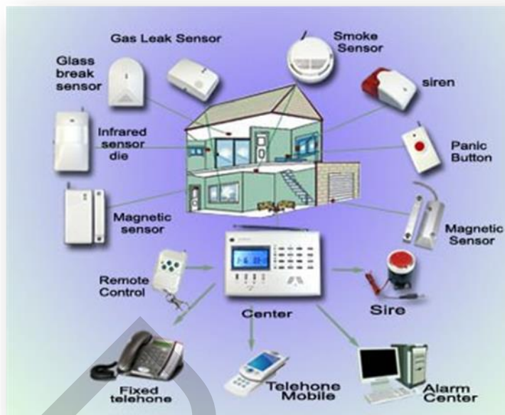
ภาพที่ 2.3 การต่ออุปกรณ์ระบบสัญญาณเตือนการบุกรุก
