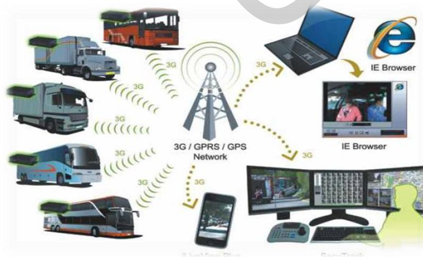
ภาพที่ 2.9 แสดงการเชื่อมต่อระบบกล้องโทรทัศน์วงจรปิดผ่านเครือข่าย 3G&GPS
