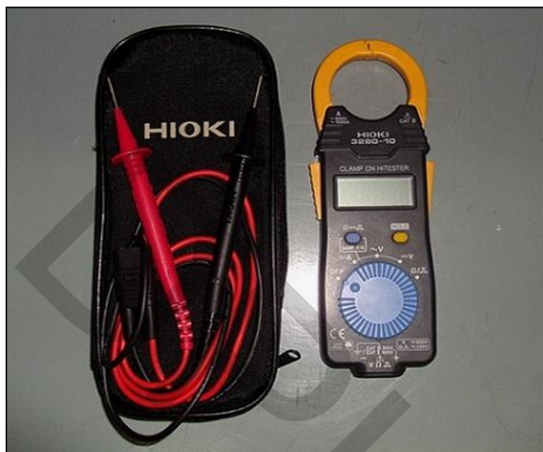
ภาพที่ 3.18 เครื่องวัดค่าทางไฟฟ้าชนิด คลิปแอมป์ ผลิตภัณฑ์ HIOKI รุ่น 3280 - 10
