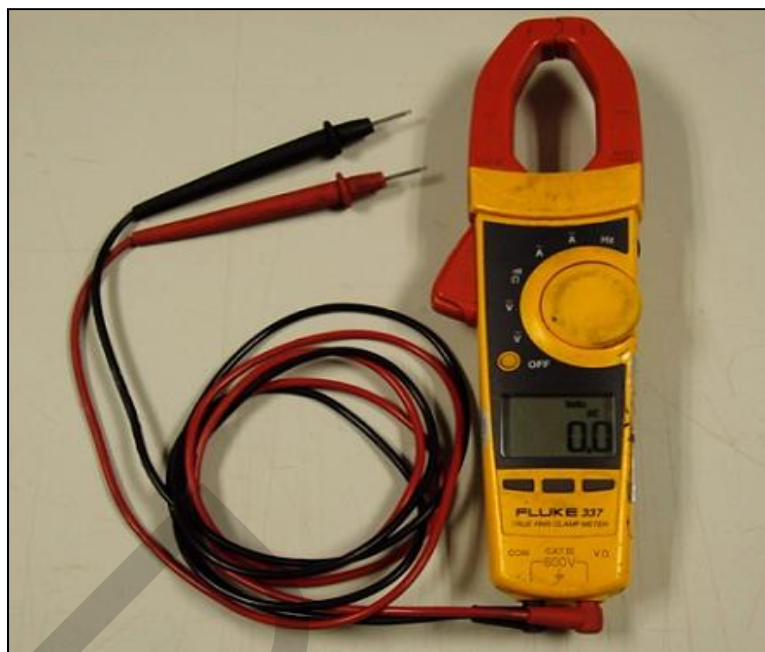
ภาพที่ 3.17 เครื่องวัดค่าทางไฟฟ้าชนิดคลิบแอมป์ ผลิตภัณฑ์ FLUKE รุ่น 337
