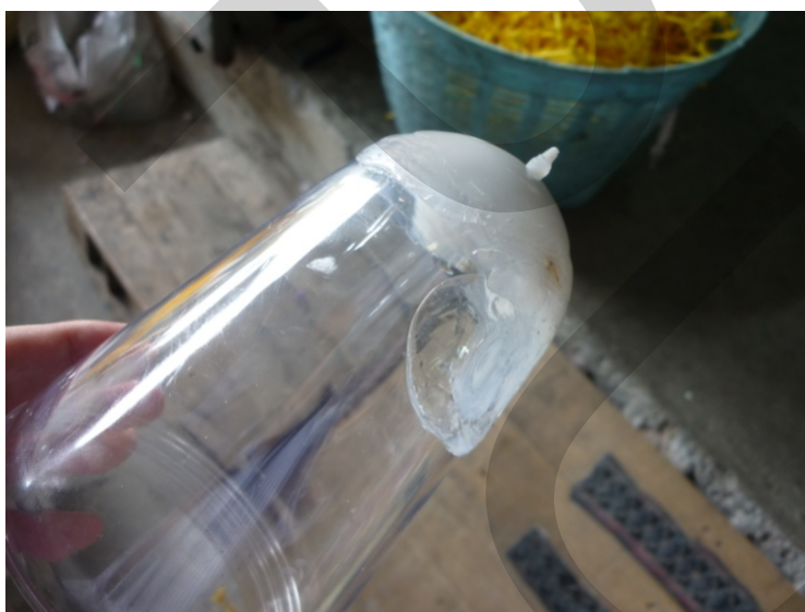
ภาพที่ 3.21 แสดงถึงลักษณะข้อบกพร่อง มีฟองอากาศเกิดขึ้น
