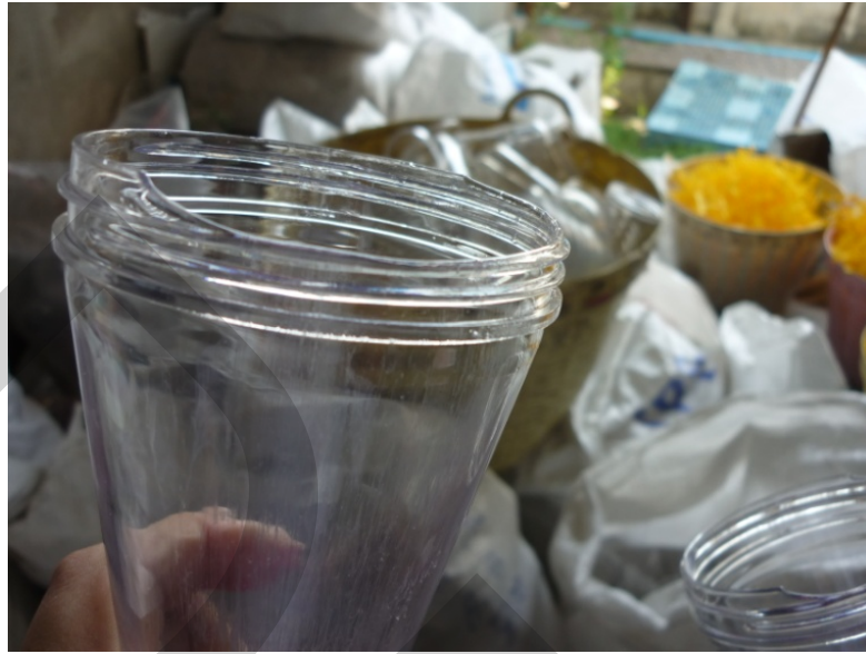
ภาพที่ 3.18 แสดงถึงลักษณะข้อบกพร่อง แบบปากไม่เต็ม
