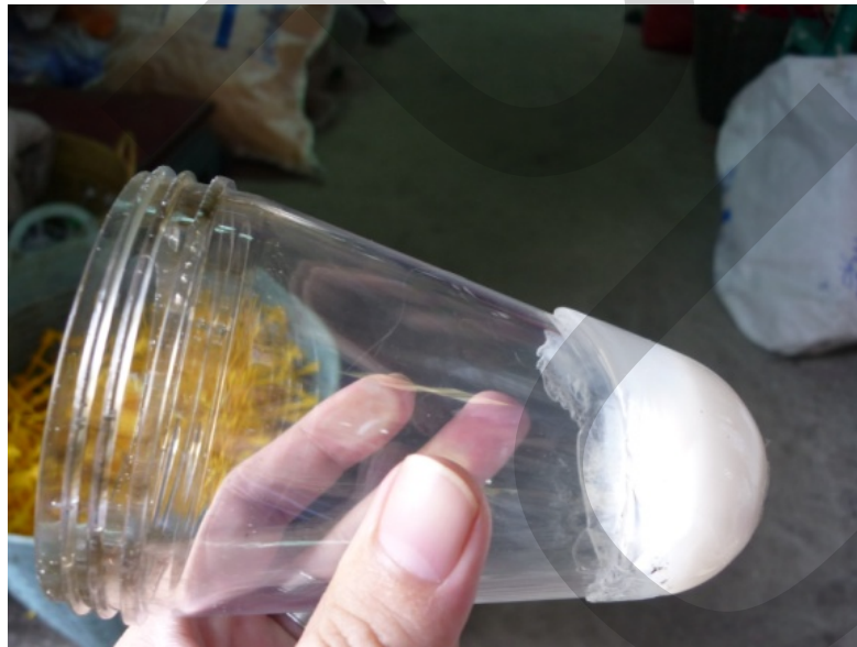
ภาพที่ 3.19 แสดงถึงลักษณะข้อบกพร่อง แบบมีเส้นใยเกิดขึ้น
