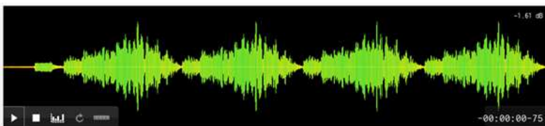
รูปที่ 4.4 รูปคลื่นเสียงแจ้งเตือนสัญญาณอัคคีภัยใหม่
