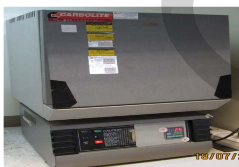
ภาพที่ 3.9 เครื่องทดสอบในการอ่านค่าความร้อน (Heating Value)
