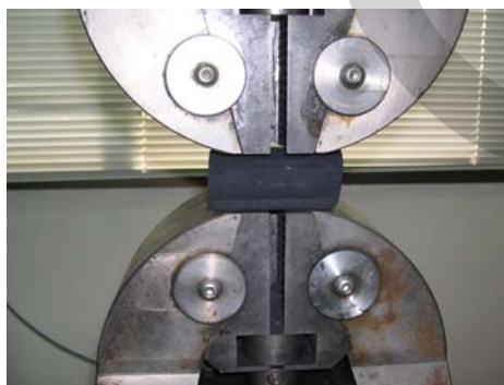
ภาพที่ 4.5 ทดสอบความแข็งของถ่านอัดแท่ง
