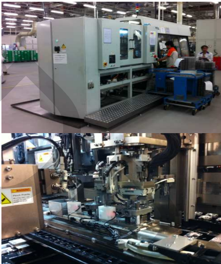
ภาพที่ 4.11 หลังจากการติดตั้ง Automatic loader machine และแสดงชุด Automatic loader
