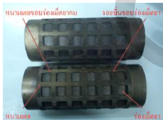
ภาพที่ 4.29 แสดงลักษณะปัญหาต่างๆของ Sealing Roller
