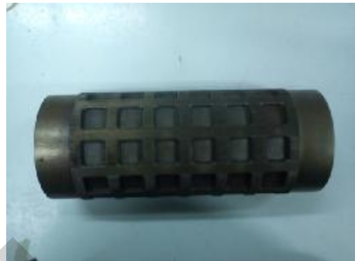
ภาพที่ 4.30 แสดงลักษณะปัญหาต่างๆของSealing Roller ก่อนทำการเปลี่ยน
