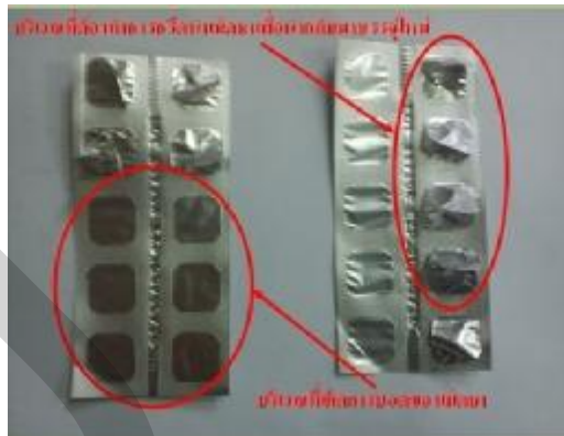
ภาพที่ 3.15 บริเวณที่เกิดการบอดของเม็ดยา และบริเวณที่ต้องทำการกรีดเม็ดยาเพื่อนำกลับมาบรรจุ ใหม่
