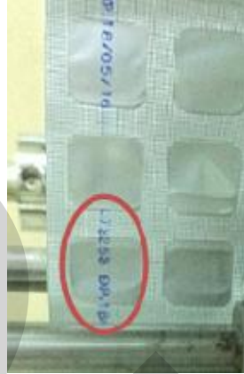
ภาพที่ 3.11 หมายเลขล็อต วันเดือน/ปี ไม่ชัดเจน
