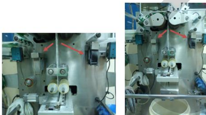
ภาพที่ 4.39 แสดงการติดตั้งพัฒนาระบายความร้อนแผ่นCellophane เพื่อแก้ปัญหารอยตัดที่เกิดขึ้นจากการตัดแบ่งแผงยา
