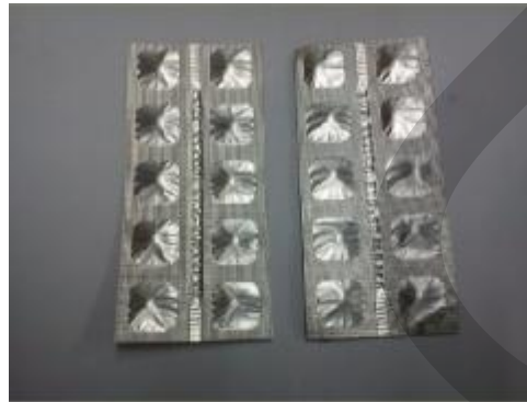
ภาพที่ 4.52 แผงยาที่ได้รับการปรับปรุงแก้ไขปัญหาการเกิดสภาวะเม็ดยาบดในแผงยาที่ทำการ บรรจุ
