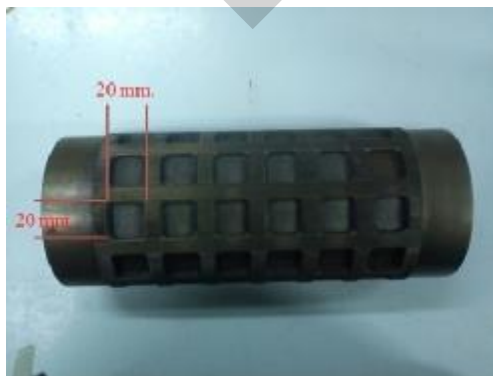
ภาพที่ 4.35 แสดงการเปรียบเทียบขนาดร่องบรรจุเม็ดยาของ Sealing Roller ก่อนและหลังการปรับปรุง
