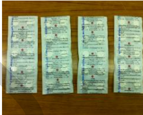
ภาพที่ 4.40 เม็ดยาที่บรรจุด้วยแผ่น Cellophane เมื่อทำการปรับปรุงเครื่องจักรแล้ว ไม่เกิดขุยจากการตัดแบ่งแผงยา
