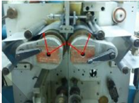
ภาพที่ 4.20 การร้อยฟอยล์ผ่าน Sealing-Roller แบบที่ 4 Material briefly pre-heated, not routed via rollers at in-feed chute. แผ่นฟอยล์จะถูกทำให้ร้อนก่อนซีล
