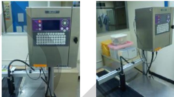
ภาพที่ 4.2 เครื่องพิมพ์ Ink Jet ขนาด 7 จุด ยี่ห้อ Markem Imaje รุ่น 9020
