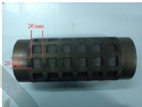
ภาพที่ 4.32 แสดงขนาดร่องเม็ดยาของSealing Roller ขนาด 20 mm. เมื่อทำการบรรจุเม็ดยาที่มีขนาดใหญ่มากว่า 10 mm. จะทำให้เกิดรอยย่นบริเวณขอบร่องเม็ดยา และเกิดการรั่วซึมได้ เมื่อนำไปทดสอบด้วยวิธี Leak Test
