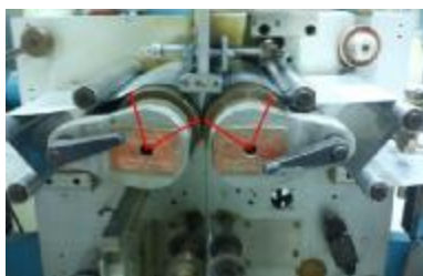
ภาพที่ 4.27 การร้อยฟอยล์ผ่าน Sealing-Roller แบบที่ 4 Material briefly pre-heated, not routed via rollers at in-feed chute และแผ่นฟอยล์จะถูกทำให้ร้อนก่อนทำการซีลอุณหภูมิที่ 170 องศาเซลเซียส และเวลาที่ใช้ในการตัดแพคเกจเท่ากับ 2 วินาที
