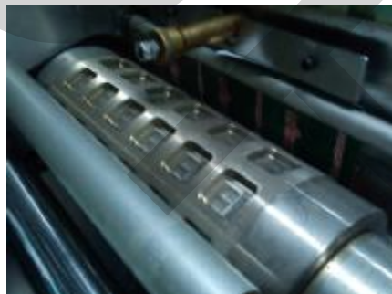
ภาพที่ 4.30 แสดงลักษณะปัญหาต่างๆของSealing Roller ก่อนทำการเปลี่ยน
