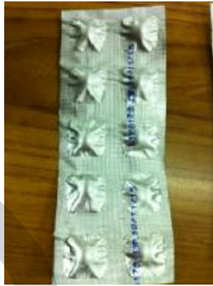
ภาพที่ 1.2 ขนาดของร่องเม็ดยาที่ไม่เหมาะสมกับขนาดเม็ดยาที่ทำให้การบรรจุทำให้เกิดรอยนที่แพ่ง อลูมิเนียมฟอยล์ เมื่อบรรจุเสร็จ
