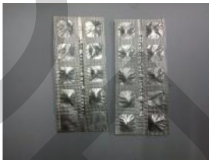
ภาพที่ 1.6 การเกิดสภาวะเม็ดยาบอดในแผงยาที่ทำการบรรจุ
