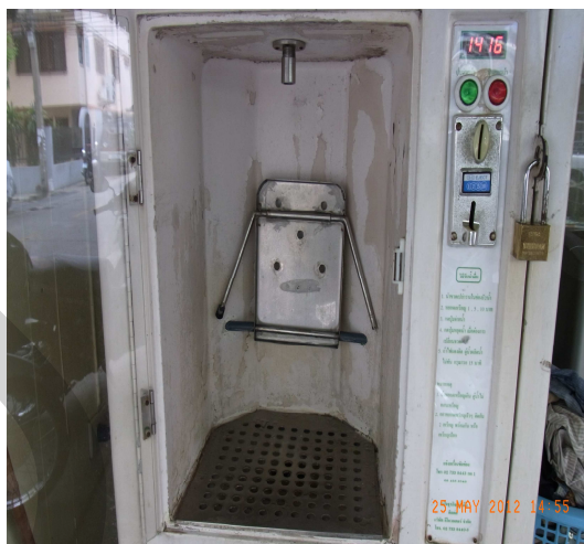
ภาพที่ 2.5 ตัวอย่างบริเวณที่วางภาชนะบรรจุองรับน้ำที่ขาดการดูแลและหัวจ่ายมีคราบสนิม
